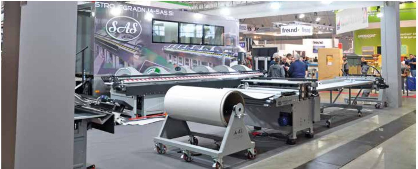
Die Biegemaschinen von SAS: HKS-CNC Profi, HKS-Cs Profi, HKS E Profi und HKS-Pf Profi biegen mit konstruktiver Verstärkung und erhöhter hydraulischer Leistung maximale Blechstärken von 1,5mm Aluminium und 2,0mm Stahl.
