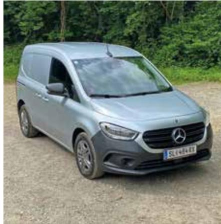
2,35 m<sup>2</sup>, das Laderaumvolumen liegt bei bis zu 2,9 m<sup>3</sup> und die maximale Zuladung beträgt 782 kg.
