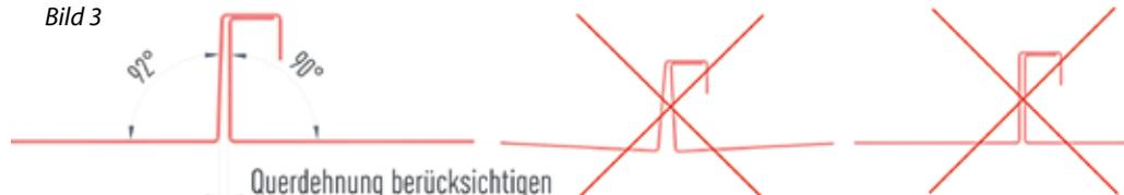
Die Querdehnung der Scharen ist zu berücksichtigen: Je nach verwendeter Profiliermaschine und System kann dieser Abstand variieren.
