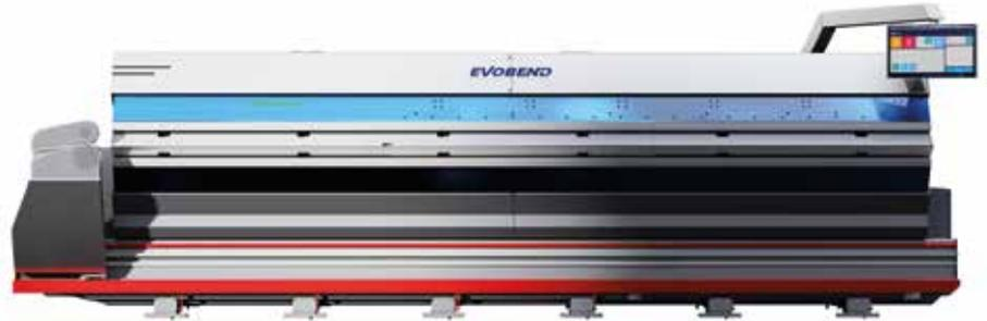
Die Doppelbiegemaschine Evobend D-Serie mit elektromechanischem Antrieb.
