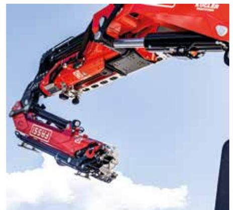
*Mittels einer Schnellwechsellvorrichtung kann der Arbeitskorb innerhalb von wenigen Minuten am Kran montiert werden.*
