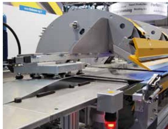
tivität gesteigert werden, auch dank der integrierten Blechwendeeinheit. Präzise und flexibel eignet sie sich auch hervorragend für Kleinserien und nicht nur für Großserien. Der Thalmann Doppelbieger ist einfach zu programmieren und kann auch mit einem Entladesystem für Blechprofile ausgestattet werden. Je nach Bedarf ist Alpemac Maschinen daher in der Lage, ein automatisiertes System vom Be- bis zum Entladen vollständig unter der Marke Thalmann zu liefern.
