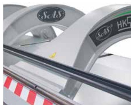
*Alle Maschinen des Modells HKS-Cs Profi sind mit Profi-Kragträger ausgestattet. Die Einlagertiefe beträgt 1.150mm.*
