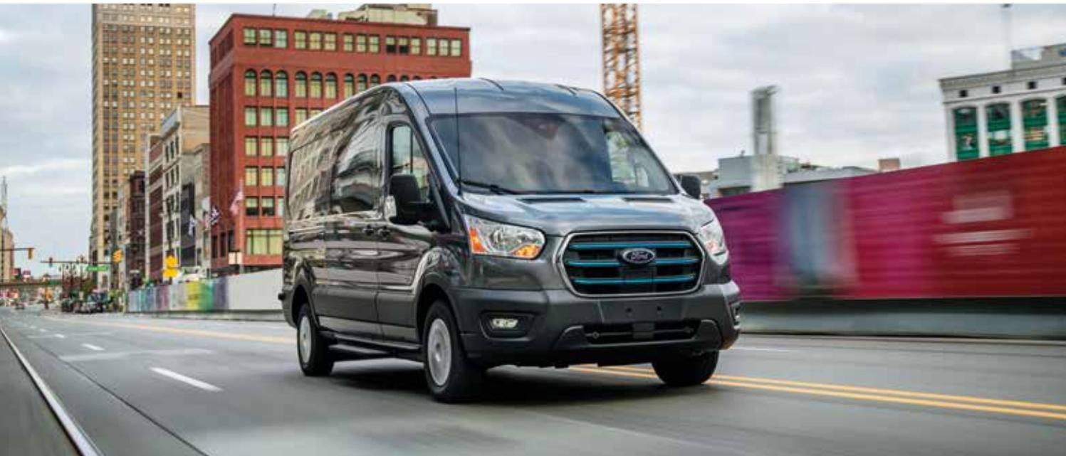
*Der kraftvolle Elektroantrieb des neuen Ford E-Transit leistet wahlweise 184 PS oder 269 PS und vereint dies mit einem Drehmoment-Spitzenwert von 430 Newtonmetern. | Fotos: © Ford of Europe (2)*
