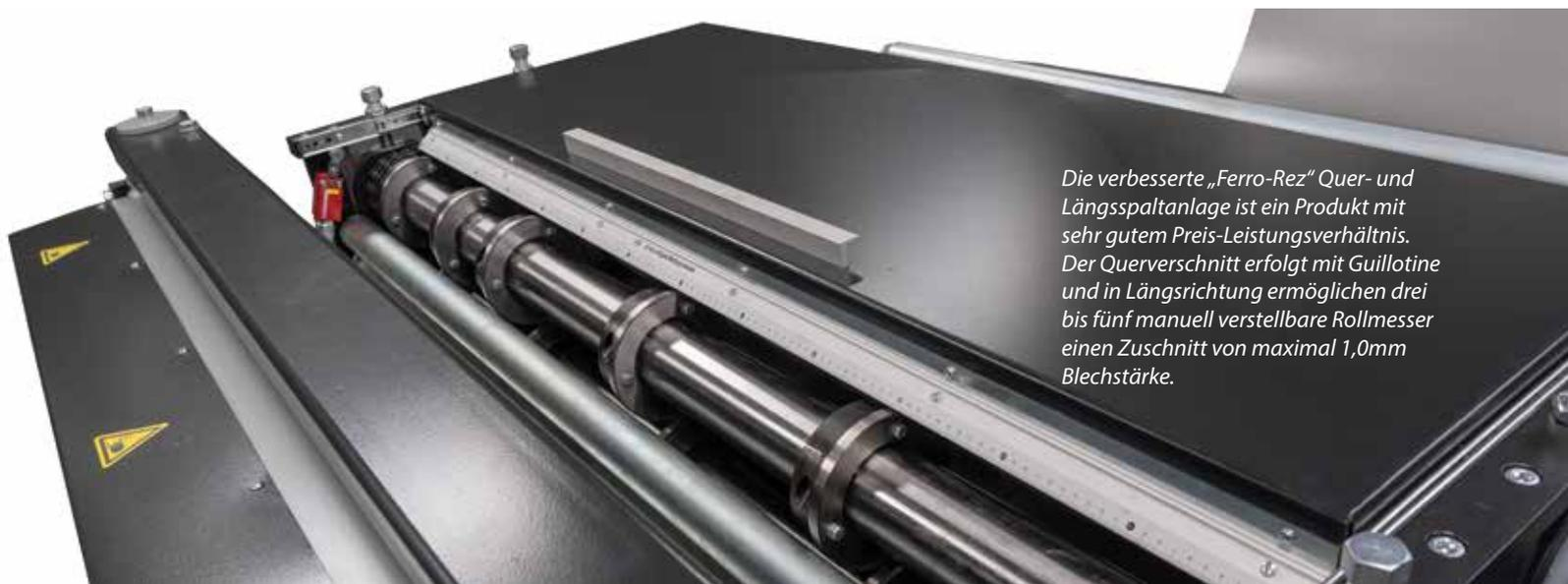
Die verbesserte „Ferro-Rez“ Quer- und Längsspaltanlage ist ein Produkt mit sehr gutem Preis-Leistungsverhältnis. Der Querverschnitt erfolgt mit Guillotine und in Längsrichtung ermöglichen drei bis fünf manuell verstellbare Rollmesser einen Zuschnitt von maximal 1,0mm Blechstärke.
