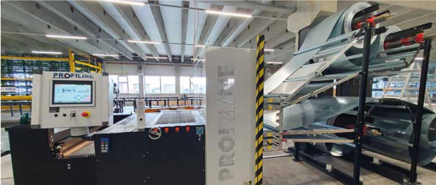
Die Materialverwaltung besteht aus einer PROFILINE Spaltanlage SP1250 TS und einem dazugehörigen Materialverwaltungslager.
