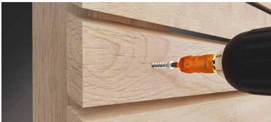
Sofern Schrauben mit HD-Antrieb und HD-Bits zusammen verwendet werden, steckt die Schraube passgenau auf dem Bit und wird durch Reibung sicher gehalten, sodass auch
