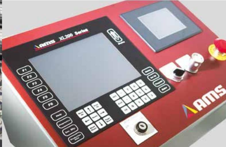
Das Produkt XL200 wurde als Alleskönner unter den Steuerungen für Profileranlagen entwickelt. Durch Softwareeinstellungen und Parameterkonfigurationen kann die Steuerung für Maschinen von jedem Hersteller adaptiert werden. | Fotos: © AMS Controls Inc. (2)
