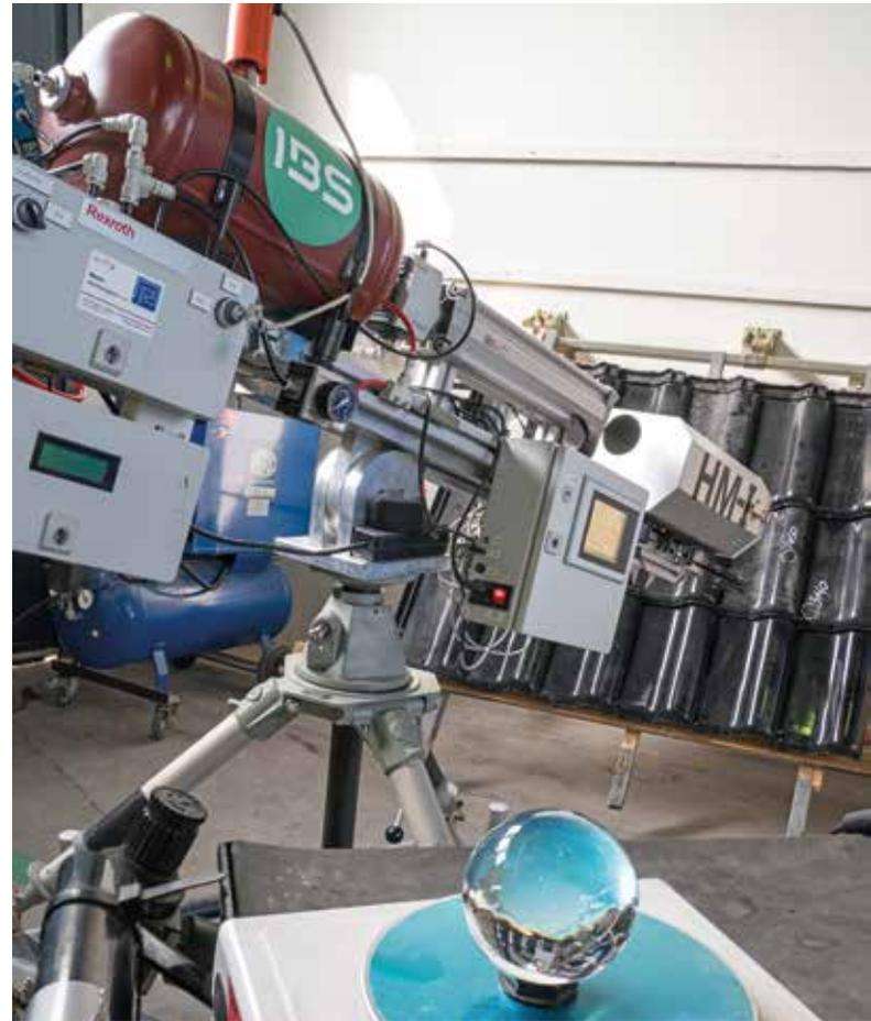
*Das Institut für Brandschutztechnik und Sicherheitsforschung (IBS) hat bereits vor Jahren ein Prüfgerät entwickelt, welches es ermöglicht, Baumaterialien der Gebäudehülle auf deren Hagelresistenz zu prüfen und zu klassifizieren.*
