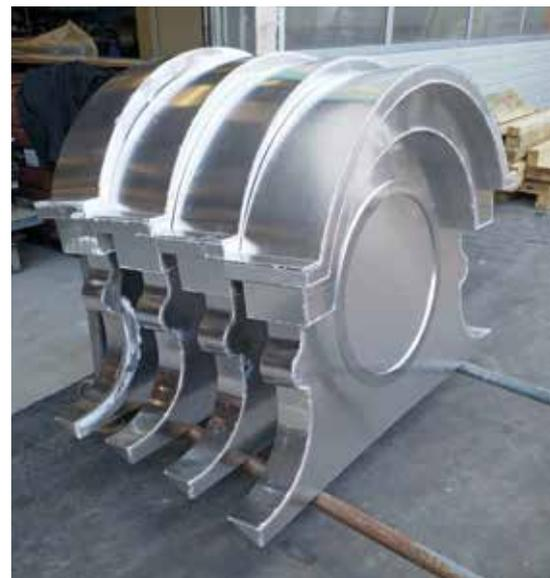
Das Wiederherstellen von Verzierungen erfolgte ausschließlich in Handarbeit. 21 Ochsenaugen wurden in traditioneller Arbeitsweise zugeschnitten, geformt und zusammengeschweißt. | Fotos: © Josef Wey AG (3)
