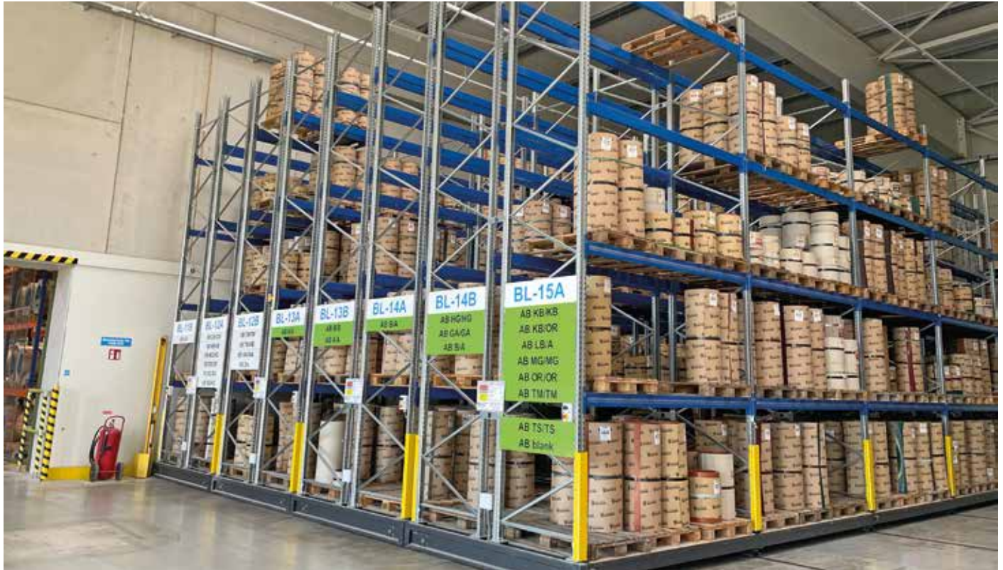
Modernste Verschiebegerätnanlage für Bandbleche mit 2.400 Palettenplätzen. | Fotos: © 2025 Michael Worahnik GmbH (5)
