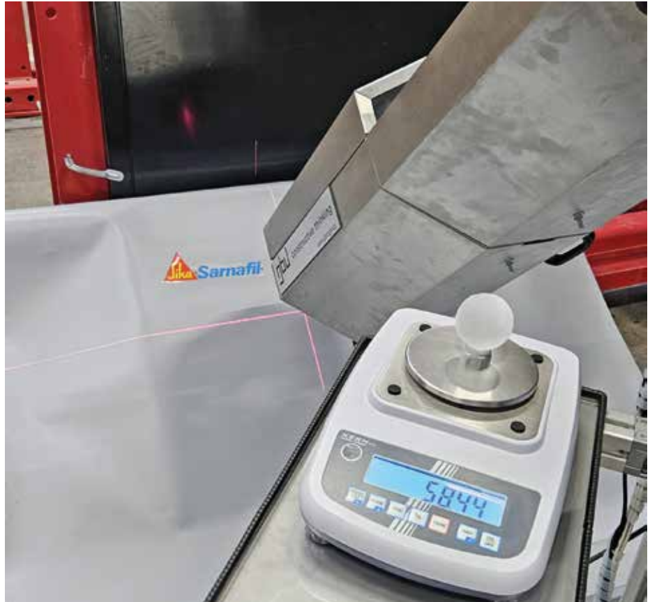
Im Labor hergestellte, genormte Eiskugeln werden mit bis zu 80 mm Durchmesser von einer entsprechenden Hagelsimulationsmaschine auf eine Geschwindigkeit von bis zu über 140km/h beschleunigt. Diese Geschwindigkeit entspricht den realen Fallgeschwindigkeiten von Hagelkörnern in der Natur.
