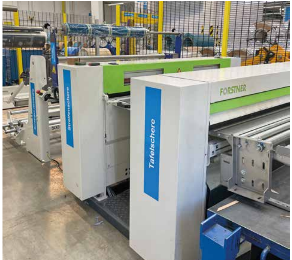
Die leistungsfähige Spaltanlage für Standard- und Sonderlängen.
