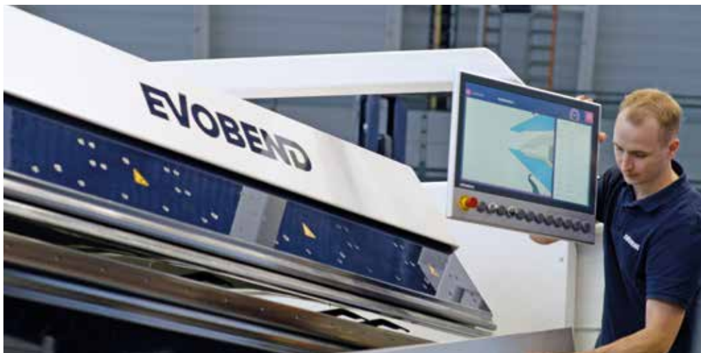
Bei den Langabkantmaschinen ist ein um bis zu 90% niedriger Energieverbrauch als bei herkömmlichen (hydraulischen) Langabkantmaschinen möglich.
