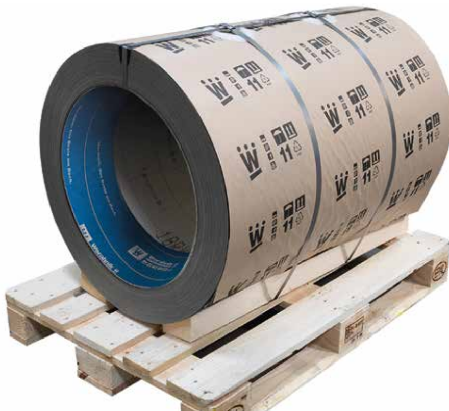
Das Worahnik Aluminium Bandblech W.15 weist ab sofort eine vollwertige Rückseite mit 25µm Polyester auf und kann dadurch als vollwertige Sicht- bzw. Wetterseite verwendet werden.
