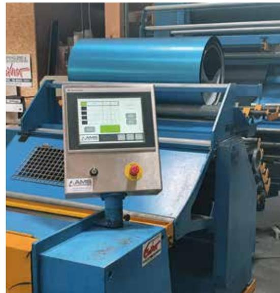
AMS Controls GmbH bietet Pathfinder Steuerungs-Retrofits für Schwenkbiegemaschinen, sowie Steuerungen für Schneide- und Profilieranlagen an. Ziel ist es, alte Maschinen funktionsfähig zu erhalten, auch um den ökologischen Footprint zu minimieren.
