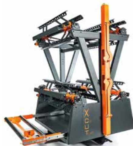
„4 Coils - 4 Tonnen - 4 m<sup>2</sup>“ ist das Motto des XCut Coil Twister 1000.
