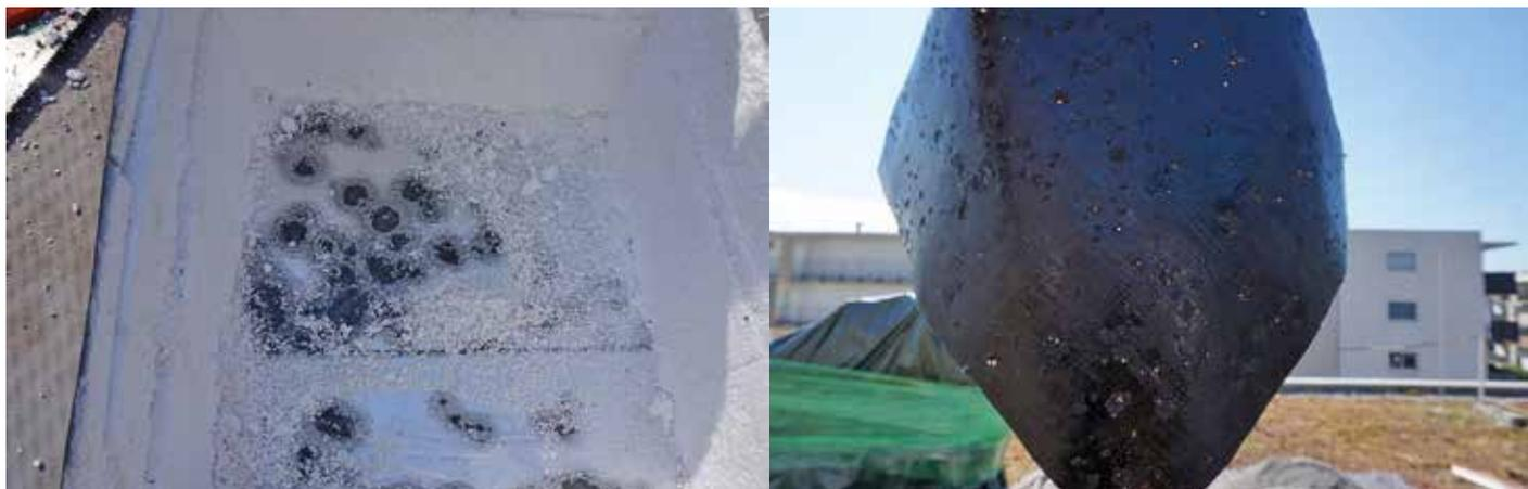
Beide Bilder zeigen die Beschädigung einer selbstklebenden Dampfsperre durch eine zu hohe Rauhtiefe des Untergrundes. | Fotos: © Kmentt (5)
