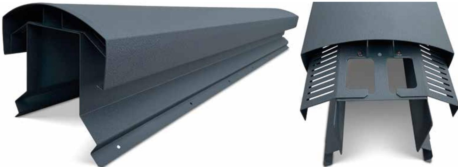
Mit dem Firstlüfter UNI bietet Worahnik eine innovative, normgerechte, technisch ausgereifte und anwenderfreundliche Produktlösung für alle gängigen Dachdeckungsarten an. Das Besondere besteht darin, dass der Firstlüfter UNI ein echtes Labyrinth-System mit einem normgerechten Lüftungsquerschnitt von 300cm<sup>2</sup> aufweist und schlagregensicher ist. | Fotos: © 2024 Michael Worahnik GmbH (4)
