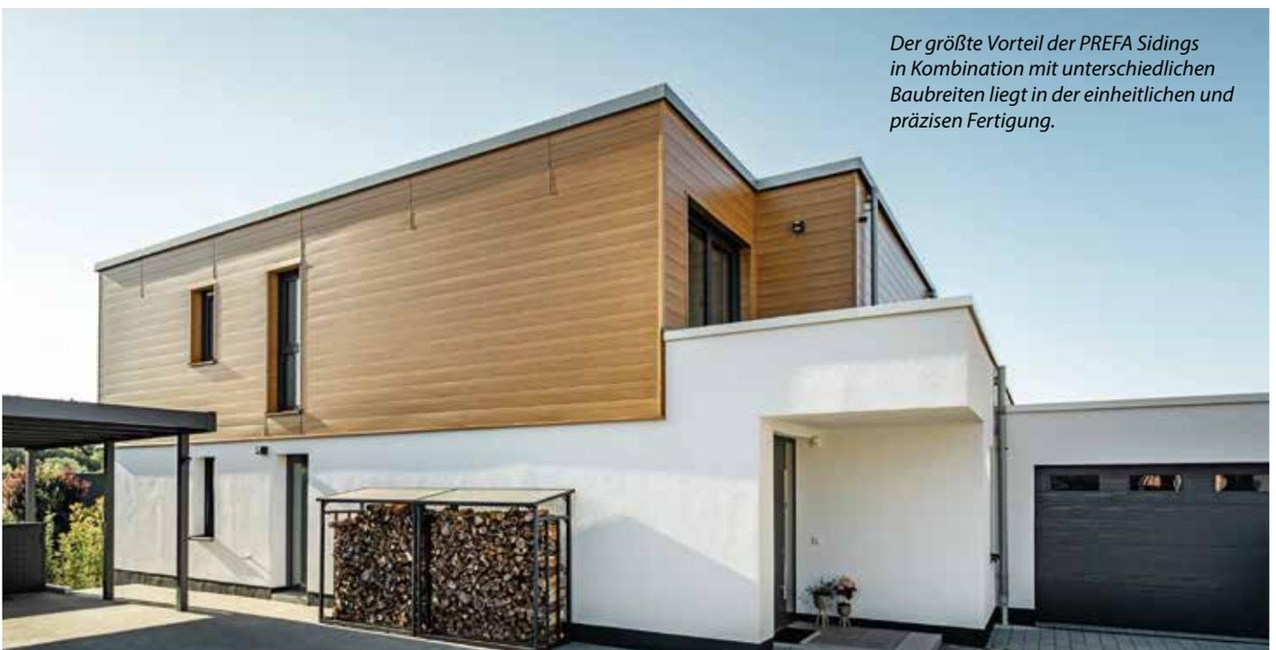
*Der größte Vorteil der PREFA Sidings in Kombination mit unterschiedlichen Baubreiten liegt in der einheitlichen und präzisen Fertigung.*
