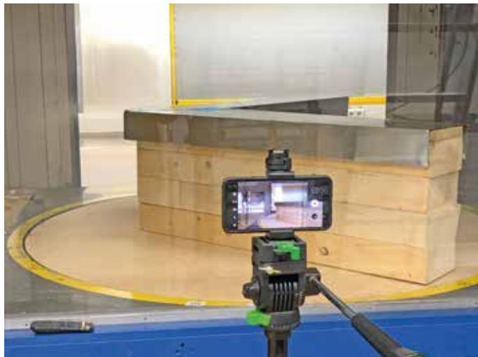
*Modell der Attikaabdeckung zu Strömungsvisualisierung: Die mit Enkolit® auf einer ca. 500 mm hohen Holz-UK befestigte 90°-Attika-Außenecke besteht aus 0,7-mm-Titanzink. Die Profilbreite beträgt 300 mm – der Überstand ca. 25 mm. Die senkrecht nach unten abgekannten Schenkel sind 100 mm hoch. | Foto: © Enke-Werk*
