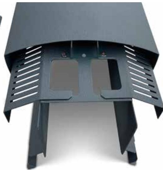
Mit dem Firstlüfter UNI bietet Worahnik eine innovative, normgerechte, technisch ausgereifte und anwenderfreundliche Produktlösung für alle gängigen Dachdeckungsarten an. Das Besondere besteht darin, dass der Firstlüfter UNI ein echtes Labyrinth-System mit einem normgerechten Lüftungsquerschnitt von 300cm<sup>2</sup> aufweist und schlagregensicher ist. | Fotos: © 2024 Michael Worahnik GmbH (2)
