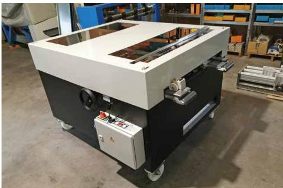
Profilmaschinen der Baureihe 2000/2000+/3000 und der PP-Primus sind standardmäßig ab Werk bereits mit Quer- und Längsschneider ausgerüstet und haben einen automatischen Einzug, der das Blech selbstständig in die Maschine transportiert. Ebenso ist ein Messwerk zur digitalen Längeneingabe angebracht, das in die Maschine in-
